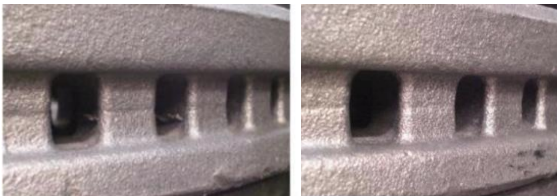
Obr. 2-19 Vlevo je část odvětrávaného brzdového kotouče vyráběného s jádrem bez aditiva; vpravo je část odvětrávaného kotouče vyráběného s jádrem (aditivo – Feranex 7530 S, 1 %), [8]
