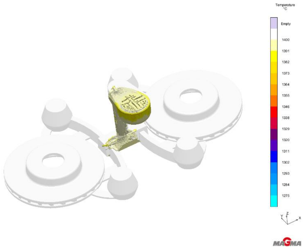
Obr. 3-10 Plnění slévárenské formy při výrobě odvětrávaného brzdového kotouče v čase 1 s po začátku odlévání
