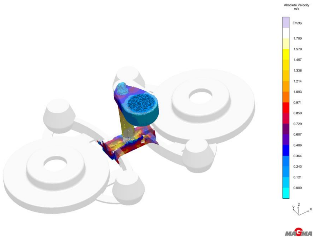
Obr. 3-17 Rychlost plnění slévárenské formy taveninou při výrobě odvětrávaného brzdového kotouče v čase 1 s po začátku odlévání
