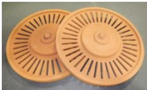
Obr. 2-18 Jádro pro výrobu odvětrávaných kotoučů vyrobená z obalované směsi HAP 120 128Z 1 s 1 % Feranexu 7530 S, [8]
