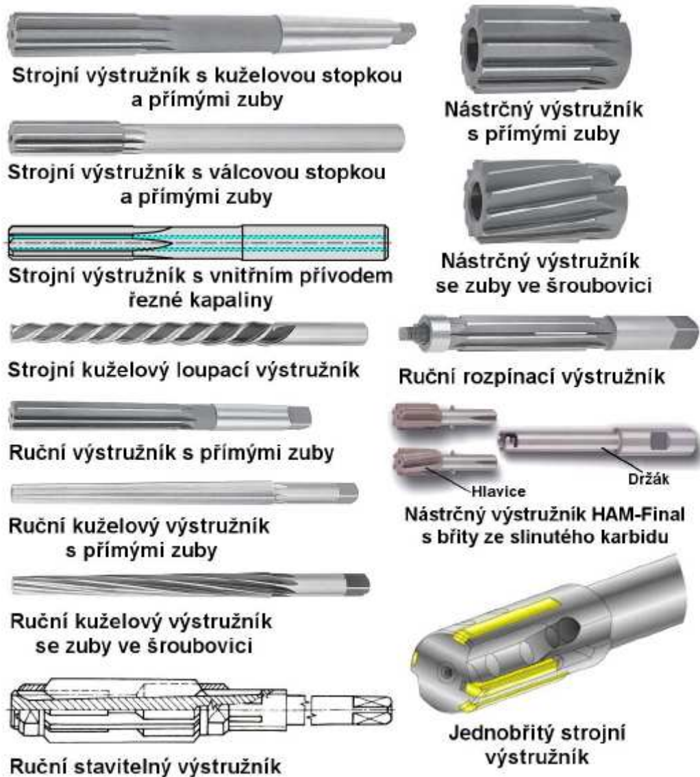
Obr. 4.5 Výstružníky 11
