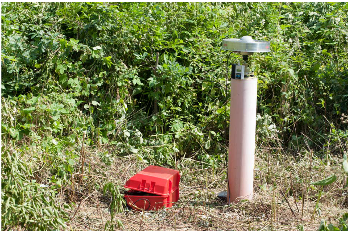
Obrázek č. 9: Uživatelský segment – GPS aparatura pro přesné geodetické aplikace.
