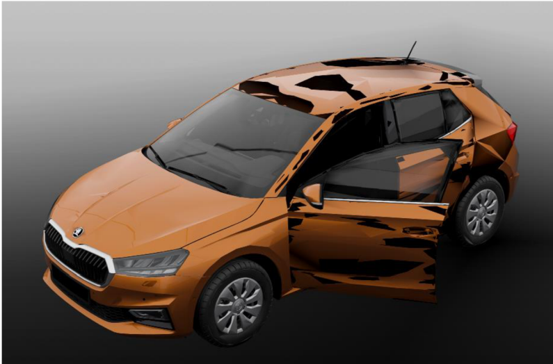
Obrázek 41 Chyby v předpočítaných stínech po decimaci s parametrem -50 Zdroj: vlastní zpracování
