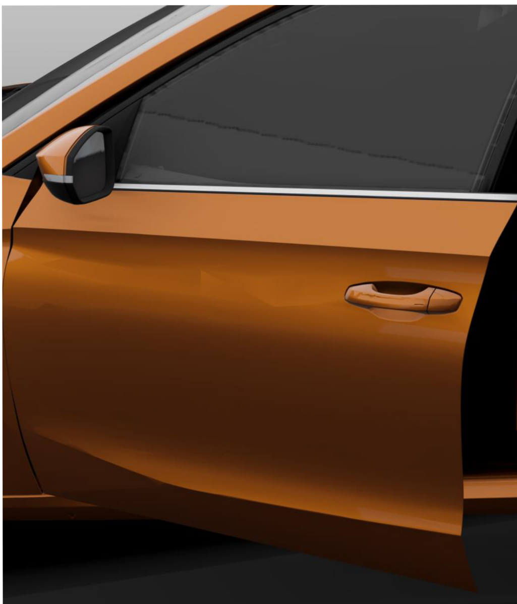
Obrázek 39 Lehká deformace geometrie předních dveří při decimaci s parametrem -45
