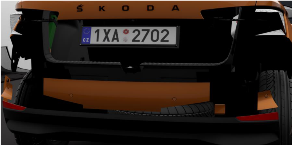
Obrázek 35 Chybné odstranění geometrií při použití funkce SimplifyStructure Zdroj: vlastní zpracování
