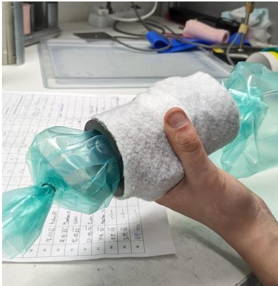
Obr. 10 Forma s protaženým vakuovým pytlek obalena odsávací rohoží.
