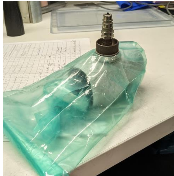
Obr. 11 Forma připravená pro VBO laminaci.
