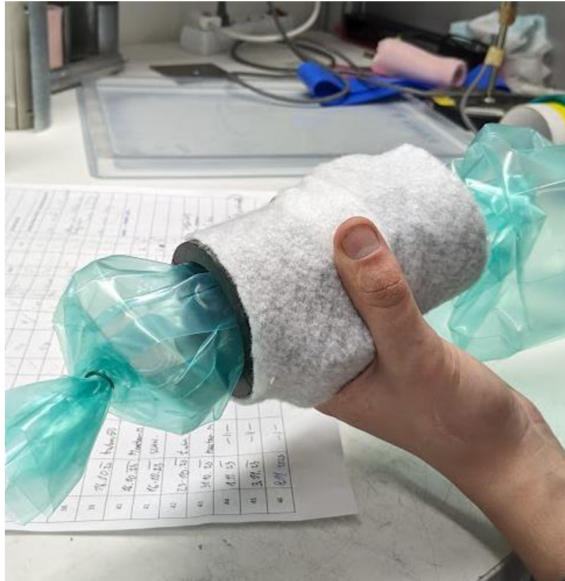
Obr. 10 Forma s protaženým vakuovým pytletem obalena odsávací rohoží.
