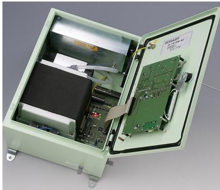
Obrázek 21 Otevřený stacionární analyzátor bioplynu BC20 [35]
