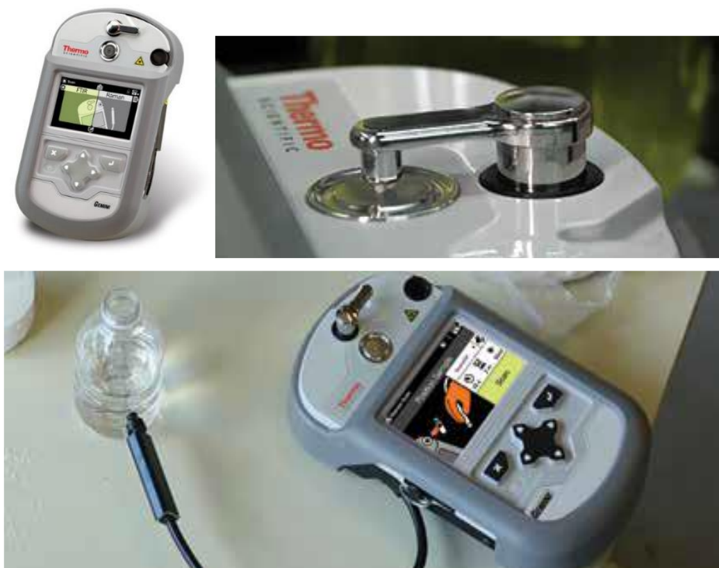
Obr. 10 – Gemini, analýza pomocí FTIR a pomocí optické sondy skrze transparentní obal 33
