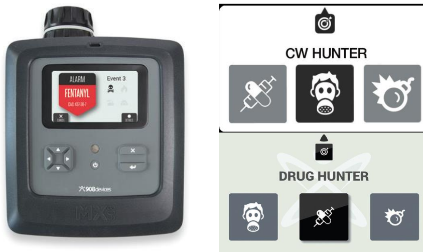
Obr. 8 – MX908 a vyobrazení displeje při režimech CW HUNTER a DRUG HUNTER 28
