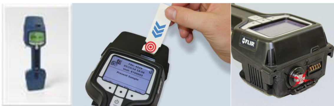
Obr. 9 - FLIR FIDO X3, analýza vzorku pomocí stěrového papírku a pomocí nasávání par 30
