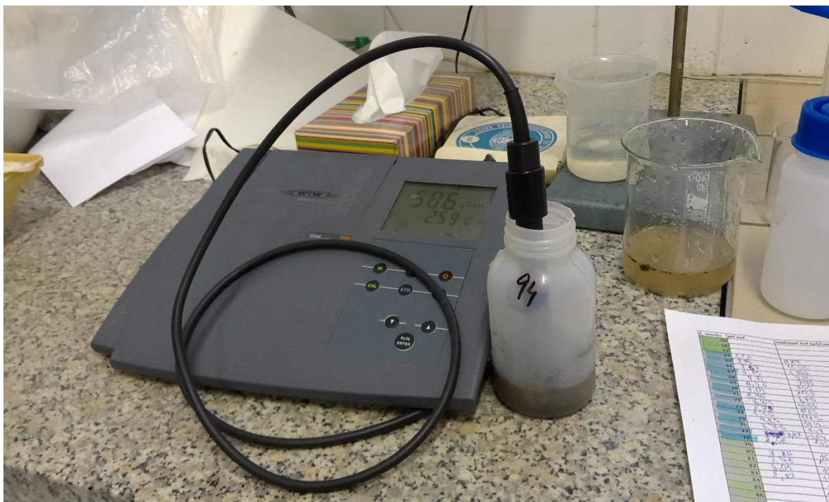
Obrázek V. Stanovení měrné vodivosti (zdroj vlastní).
