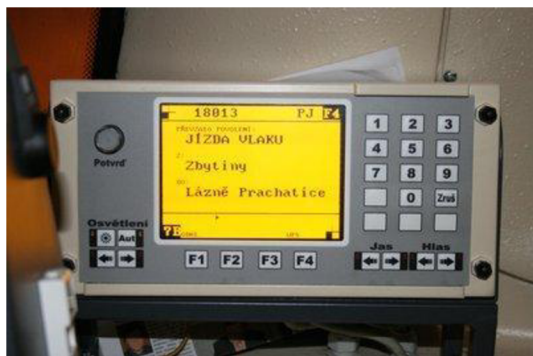
Obr. 13: Terminál umístěný na drážním vozidle typu RBV-100. [10]
