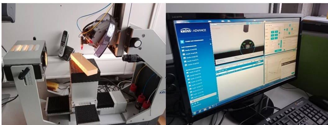
Obrázek 3 Goniometr a měření úhlu smáčení
