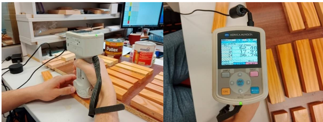
Obrázek 5 Spektrofotometr a měření barvy
