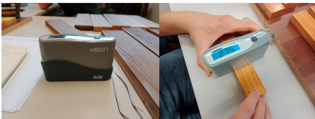
Obrázek 4 Leskoměr a měření hodnot lesku
