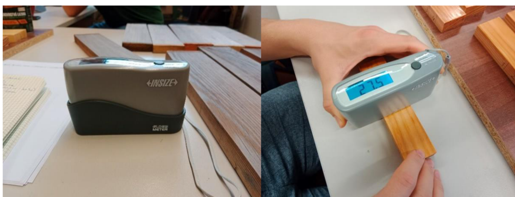
Obrázek 4 Leskoměr a měření hodnot lesku
