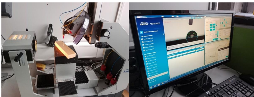
Obrázek 3 Goniometr a měření úhlu smáčení
