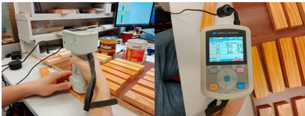
Obrázek 5 Spektrofotometr a měření barvy
