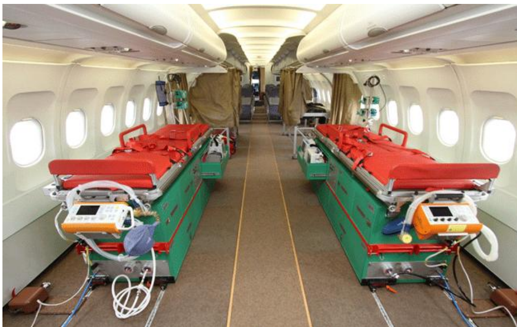
Obrázek 6. Airbus A-319 přestavěný na přepravu raněných STRATEVAC (Kouba, 2011).
