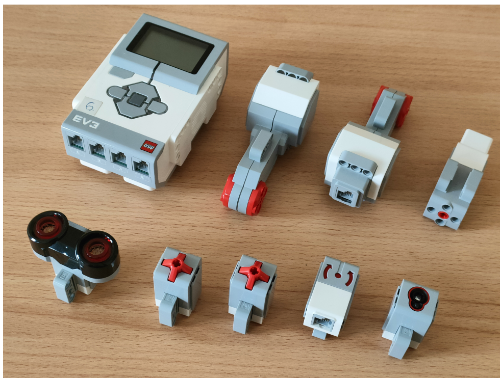
Obrázek 1: Horní řada, zleva: EV3 Brick, dva velké motory a střední motor Dolní řada, zleva: ultrazvukový, dva dotykový, gyroskopický a barevný senzor
