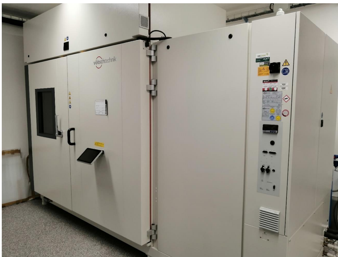
Obr. 3.5: Klimatická komora Vötsch Sun 3600
