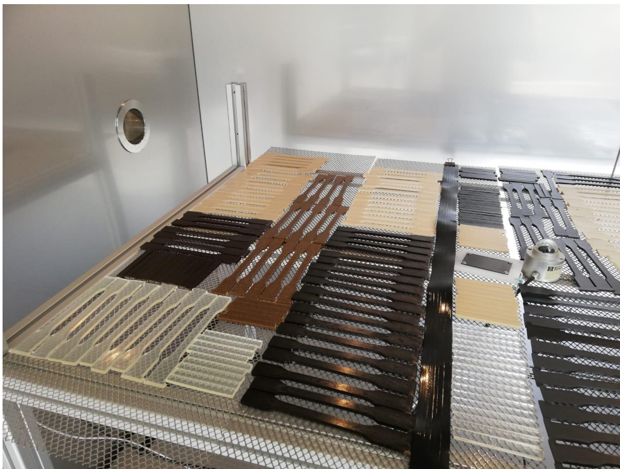
Obr. 3.7: Zkušební tělesa v klima komoře
