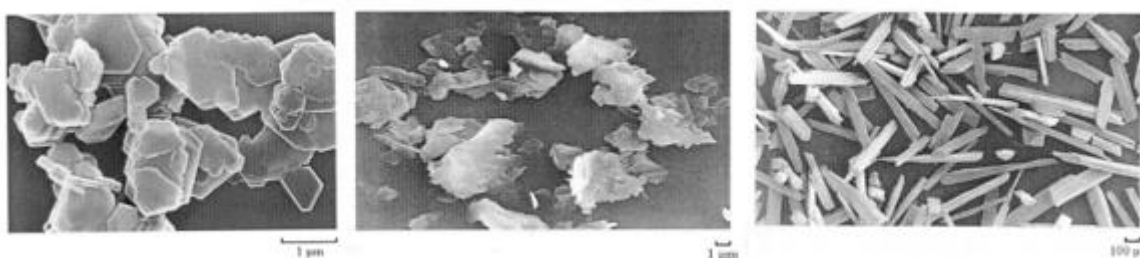
Obr. 2.8: Příklady tvarů částicových plniv – zleva: kaolín, mastek, wollastonit [33]
