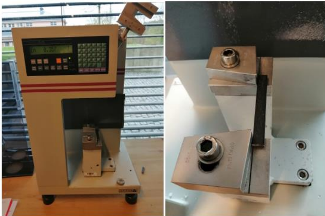
Obr. 3.13: Rázové kladivo Resil Ceast 5.5 (vlevo) a umístění zkušebního tělesa při zkoušce rázové houževnatosti (vpravo)
