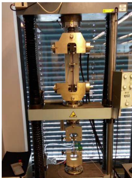
Obr. 3.10: Trhací stroj Tira Test 2300 pro tahovou zkoušku
