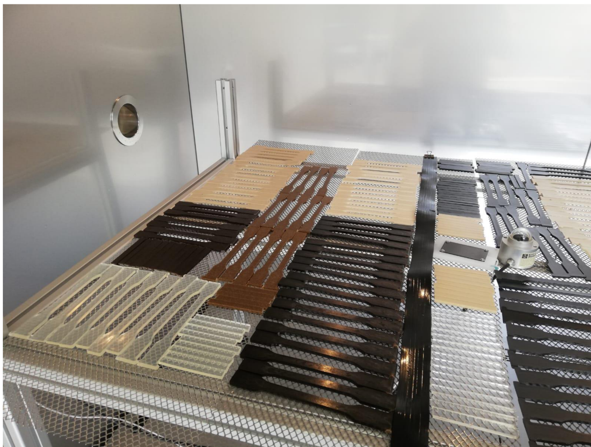
Obr. 3.7: Zkušební tělesa v klima komoře
