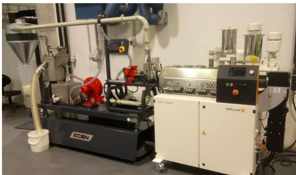
Obr. 3.2: Kompaundační stroj Collin Lab-Line ZK 2TE s granulační jednotkou Econ Ewa 10
