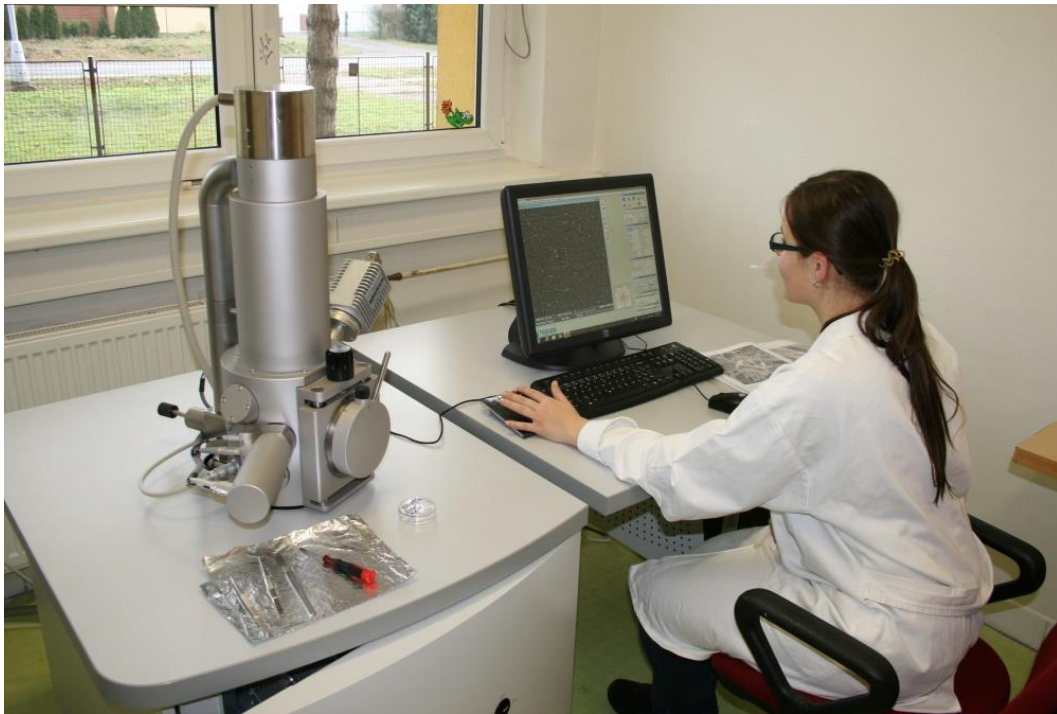
Foto 21: Skenovací elektronový mikroskop TESCAN Vega 3 s mikroanalýzátorem EDX
