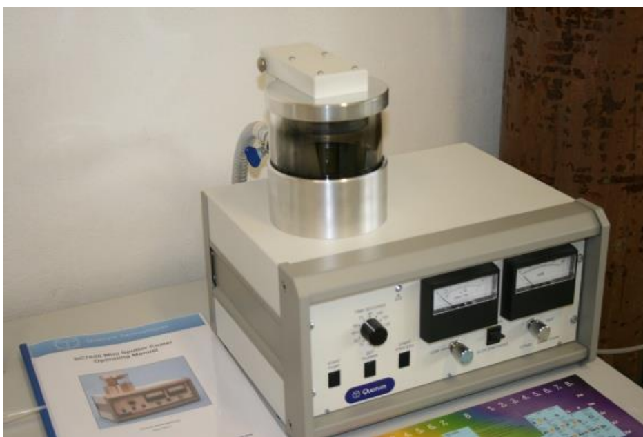
Foto 8: Napařovací zařízení Au/Pd
