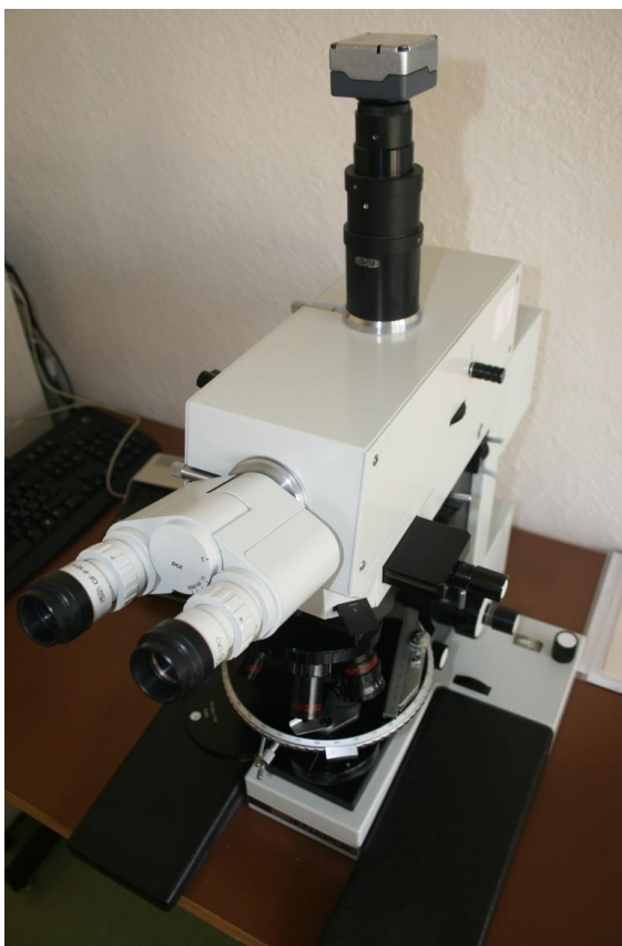
Foto 13: Optický mikroskop JENAPOL s PLM/PCM se CCD kamerou
