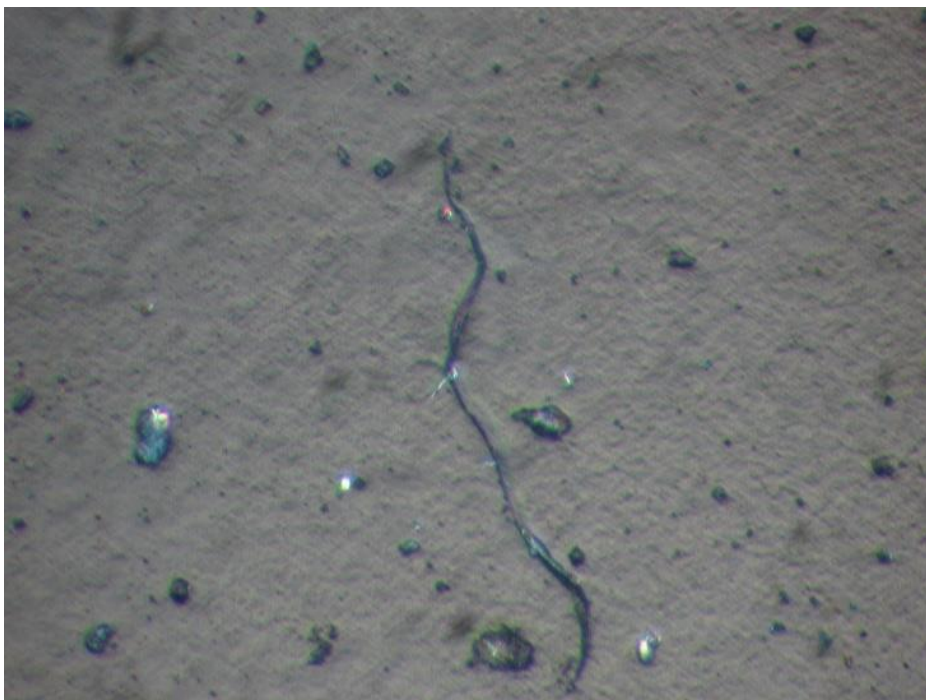
Foto 16: Chryzotilová vlákna (PLM), zvětšení 500x, horní osvit
