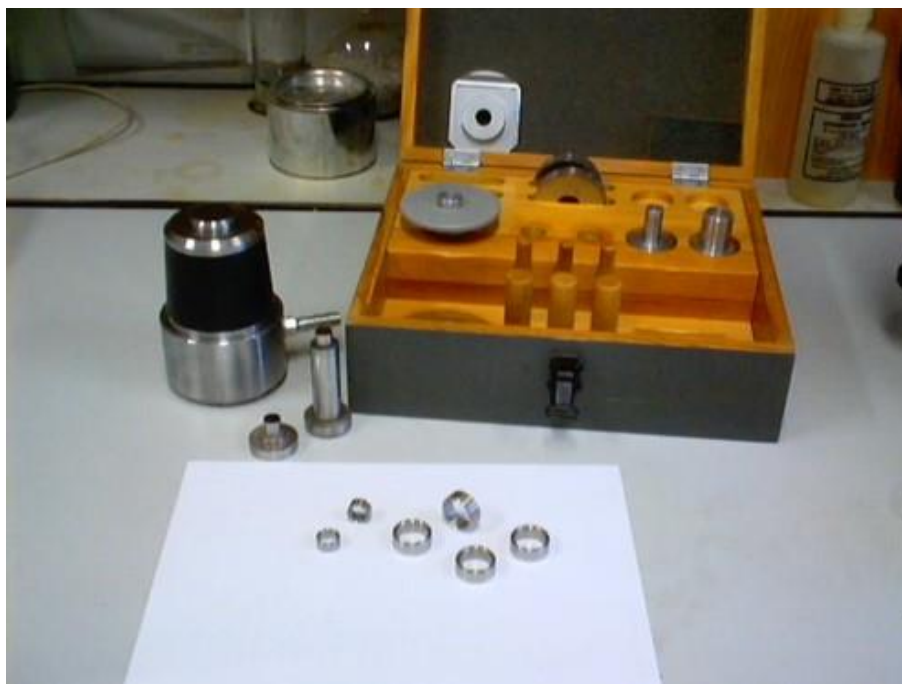
Foto 2: Příprava na tabletaci vzorku v opticky inertním materiálu (KBr)
