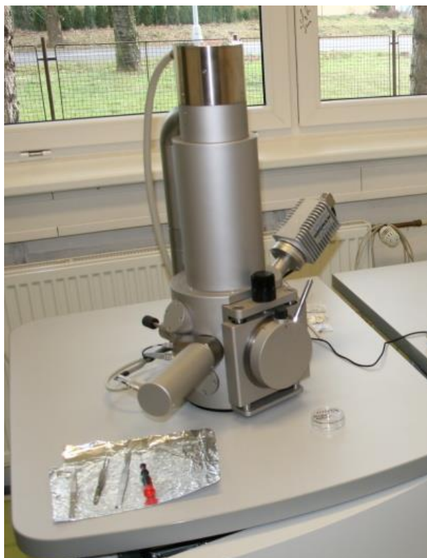
Foto 6: Skenovací elektronový mikroskop Tescan Vega 3 s mikroanalyzátozem EDX
