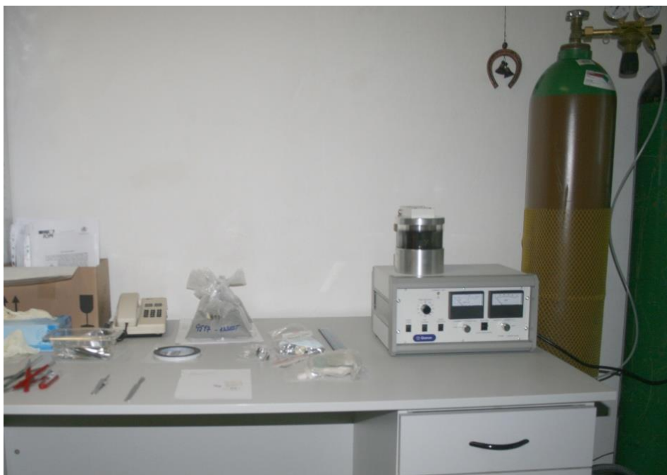
Foto 22: Napařovací zařízení Au/Pd, tlaková láhev s argonem
