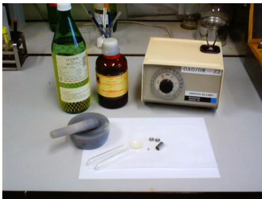
Foto 1: Drcení vzorku v achátové třecí misce s práškem KBr
