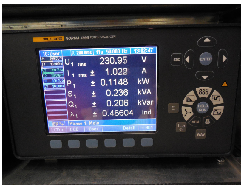
Obrázek 15 – Výkonový analyzátor Fluke NORMA 4000
