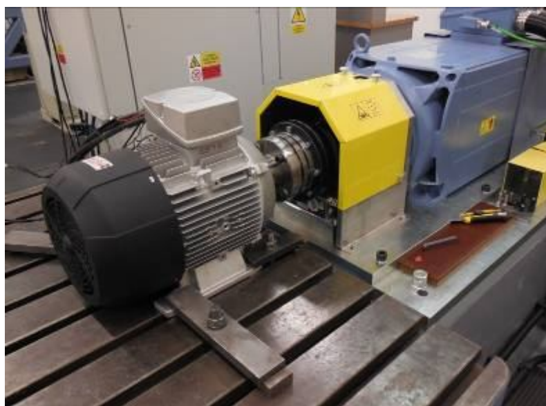
Obrázek 14 – Měřený asynchronní motor ukotvený ke zkušební stoličce a připojený přes spojku k dynamometru
