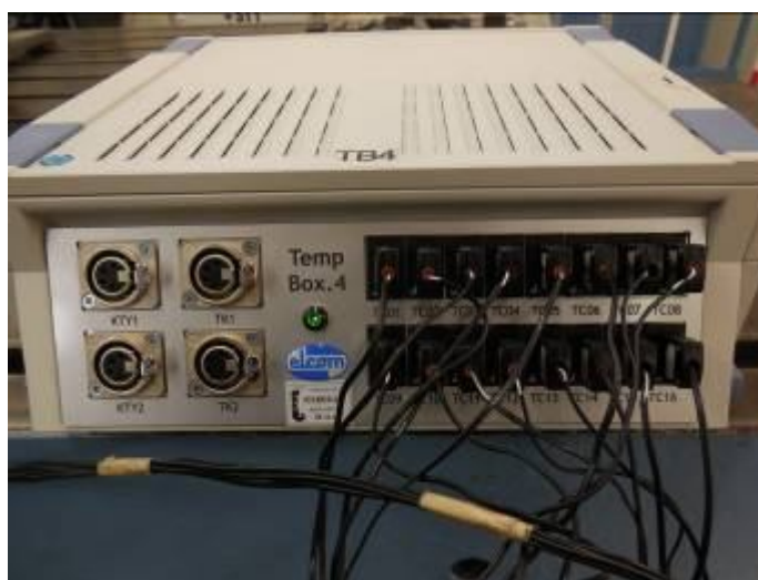
Obrázek 17 – Přenosný přístroj pro sběr dat z termočlánků
