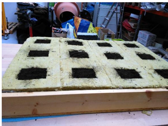
Obr. 4-6: Panel s hydrofilní vlnou s předchystanými otvory a vyplněný substrátem pro výsadbu rostlin
