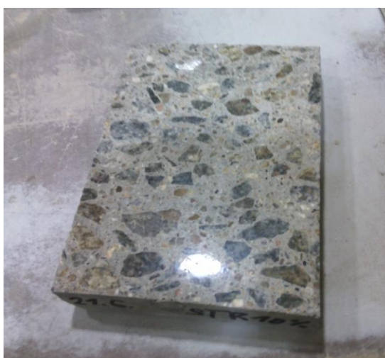
Obrázek 8: Příprava těles pro stanovení obsahu vzduchu ve ztvrdlém betonu
