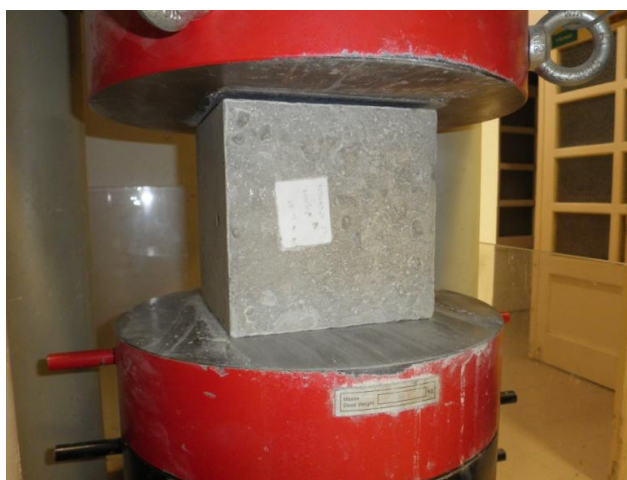
Obrázek 6: Zkouška pevnosti betonu v tlaku (metakaolin 5 %)
