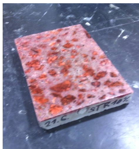
Obrázek 8: Příprava těles pro stanovení obsahu vzduchu ve ztvrdlém betonu
