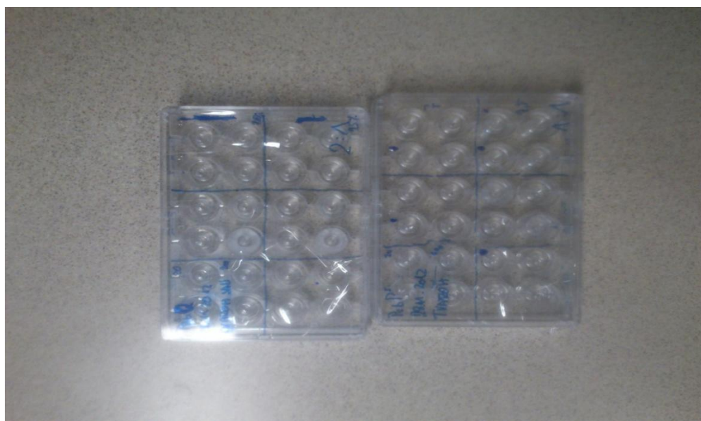
Obrázek 7 Krystalizace metodou sedící kapky (foto autor)
