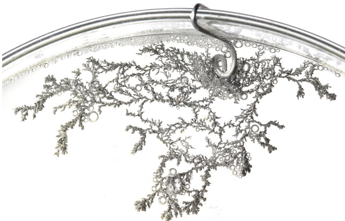
Obr. 40: Fraktální struktura vyloučeného cínu při elektrolýze
