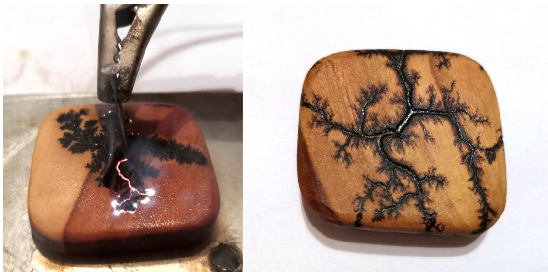
Obr. 39: Vypalování Lichtenbergových obrazců do destiček (vlevo) a detail vypálené fraktální struktury (vpravo)
