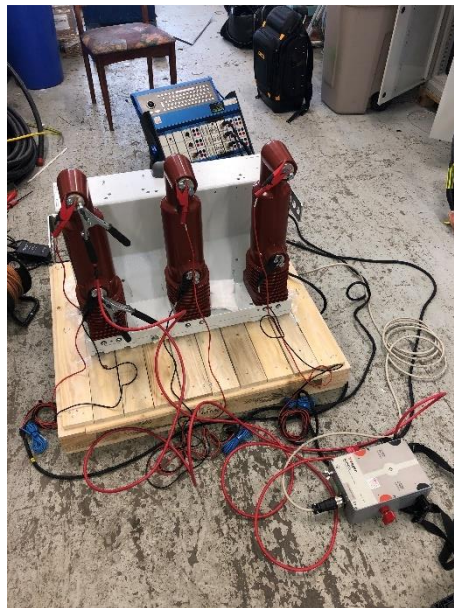
Obr. 8.3 Meranie prechodových odporov na VD4.
