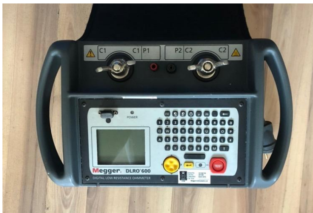
Obr. 9.6 Použitý merací prístroj DLRO 600
