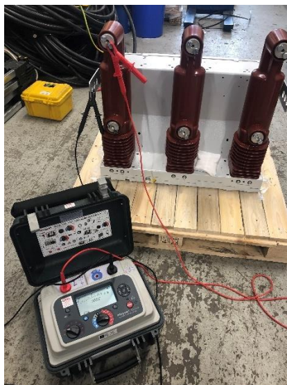
Obr. 8.1 Meranie izolačných stavov.
