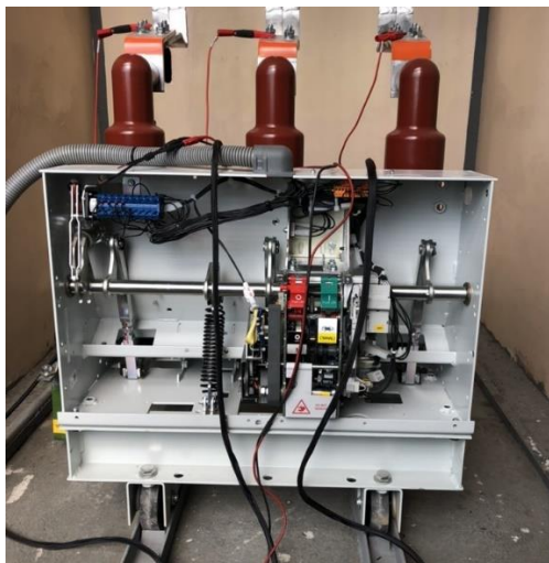
Obr. 8.8 Meranie vypínacích časov používaného vypínača VD4.
