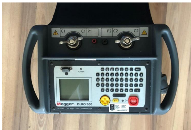
Obr. 9.6 Použitý merací prístroj DLRO 600
