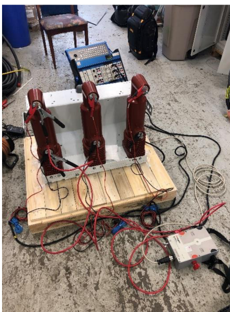
Obr. 8.3 Meranie prechodových odporov na VD4.
