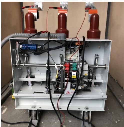
Obr. 8.8 Meranie vypínacích časov používaného vypínača VD4.
