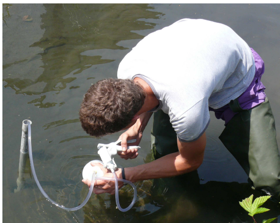
Obr. 3 Zařízení na odběr IV
