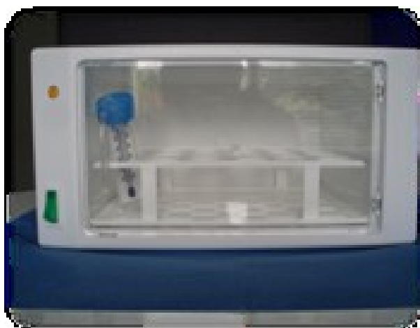
Obr.3. Inkubátor s prostředím pro určení výsledku testu
