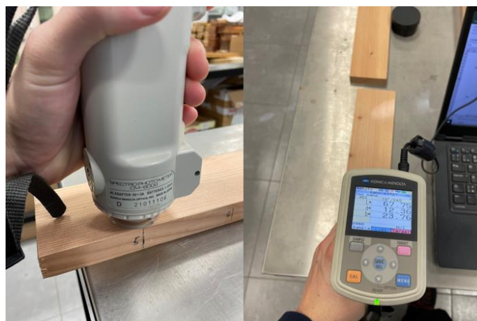
Obrázek 10: Ukázka měření se spektrofotometrem
