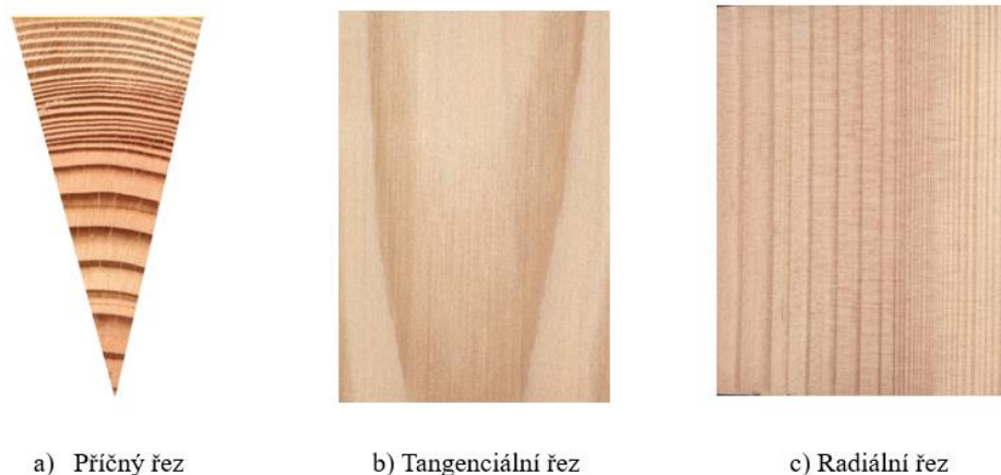
Obrázek 1: Makroskopické řezy douglasky tisolisté: a) Příčný řez, b) Tangenciální řez, c) Radiální řez
