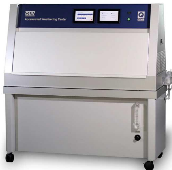
Obrázek 4: UV zkušební komora pro testování nátěrů
