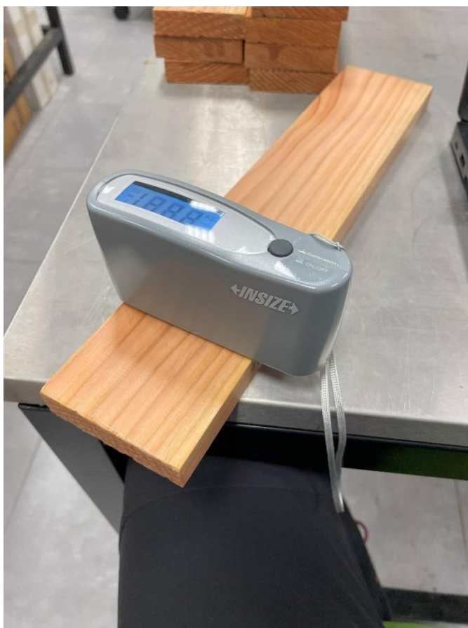
Obrázek 8: Leskoměr INSIZE ISQ - DG6
