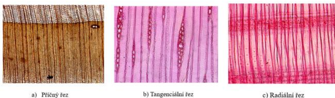
Obrázek 2: Mikroskopické řezy douglasky tisolisté: a) Příčný řez, b) Tangenciální řez, c) Radiální řez
