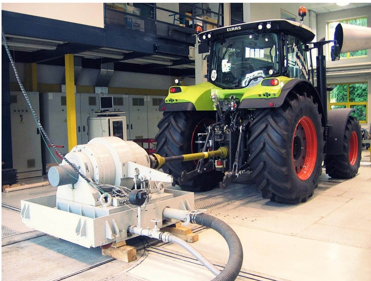
Obr. 2.3 Traktor Claas Arion 640 CMATIC napojen na dynamometr V 500.
