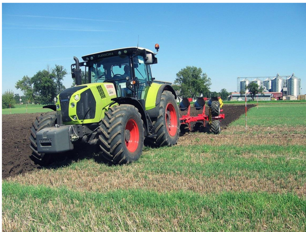
Obr. 3.9 Traktor Claas Arion 640 s pluhem Pöttinger během zkoušek, pohled zepředu.
