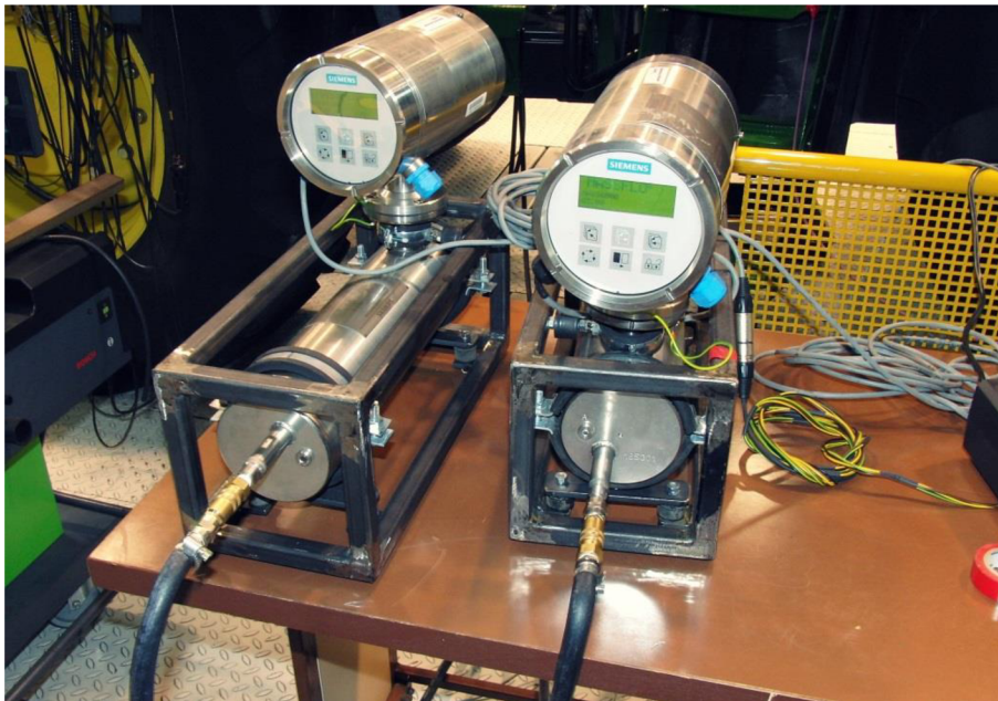
Obr. 2.4 Hmotnostní průtokoměry paliva Coriolis Sitrans FC MassFlow Mass 6000.
