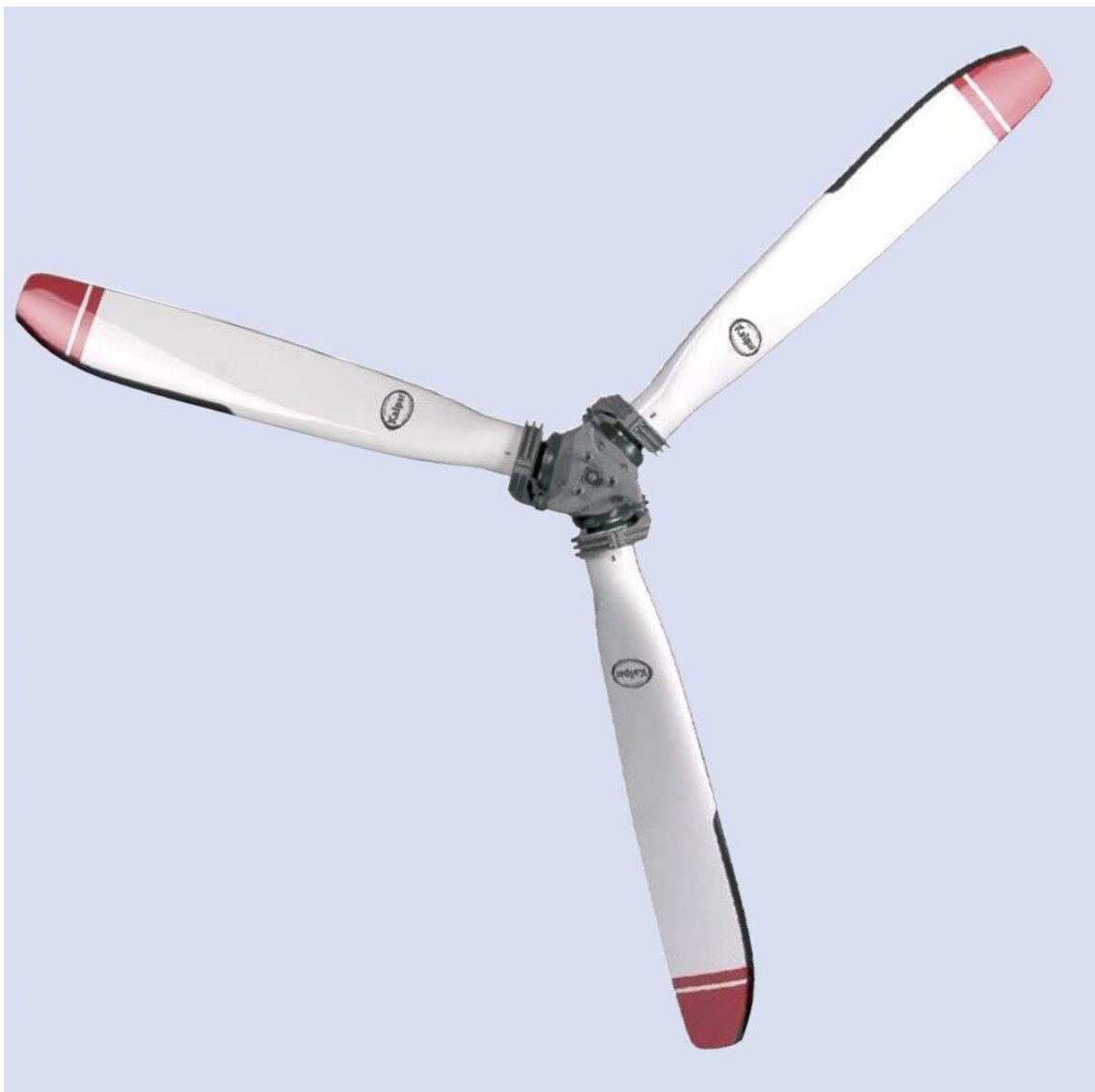
Obr. 2-21 Vrtuľa Kaspar KA-2/3-LT [46]
