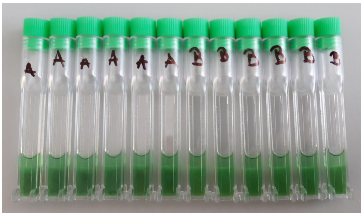
Obr. 20 – Vizuální porovnání stability vzorku A a B po odstředování při teplotě 25 °C po 53 dnech stárnutí
