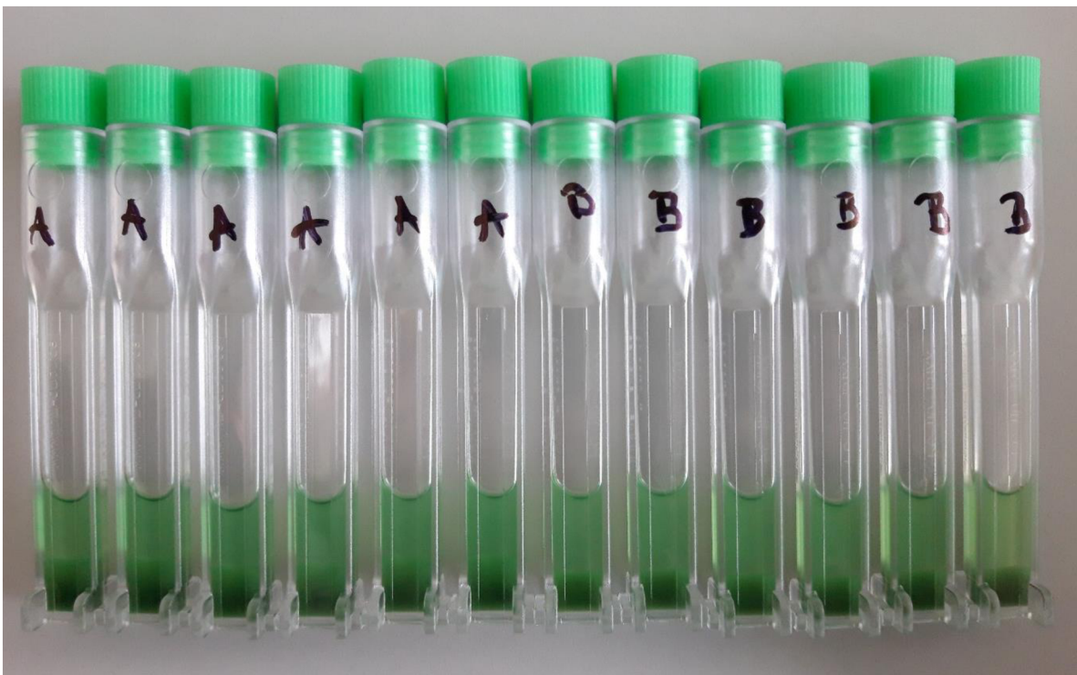
Obr. 18 – Vizuální porovnání stability vzorku A a B po odstředování při teplotě 37 °C
