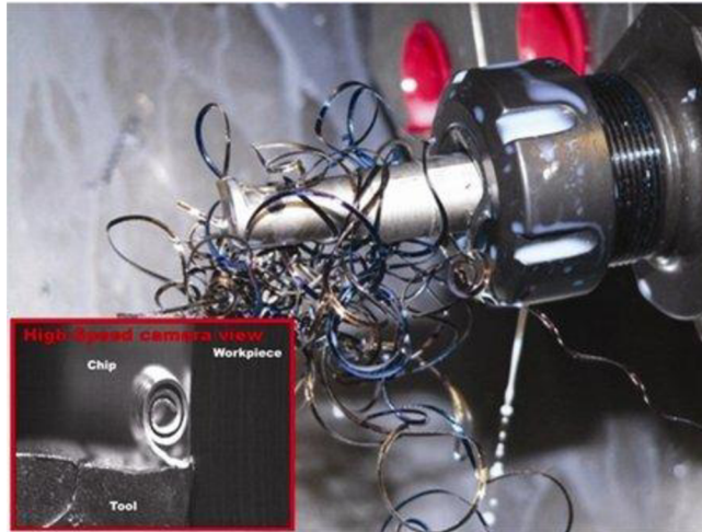
Obrázek 20. Funkce nástroje a tvorba třísky [17].
