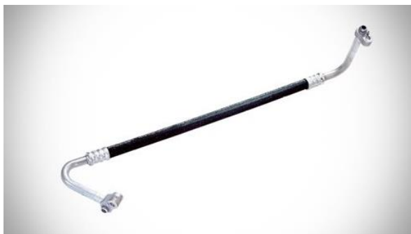
obr. 2-1 Obrázek potrubního celku klimatizace [2].
