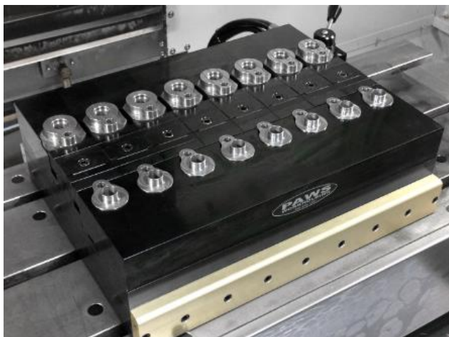
obr. 2-17 Přípravek PAWS workholding s hydraulickou deskou [42].
