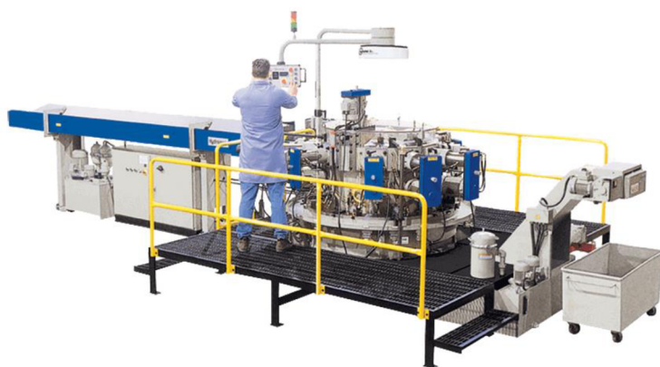
obr. 2-2 Obrázek transferového stroje HB 45-12 [9].
