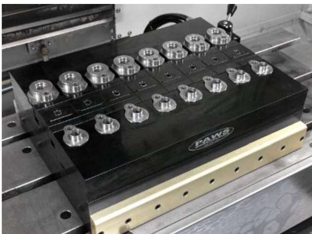
obr. 2-17 Přípravek PAWS workholding s hydraulickou deskou [42].
