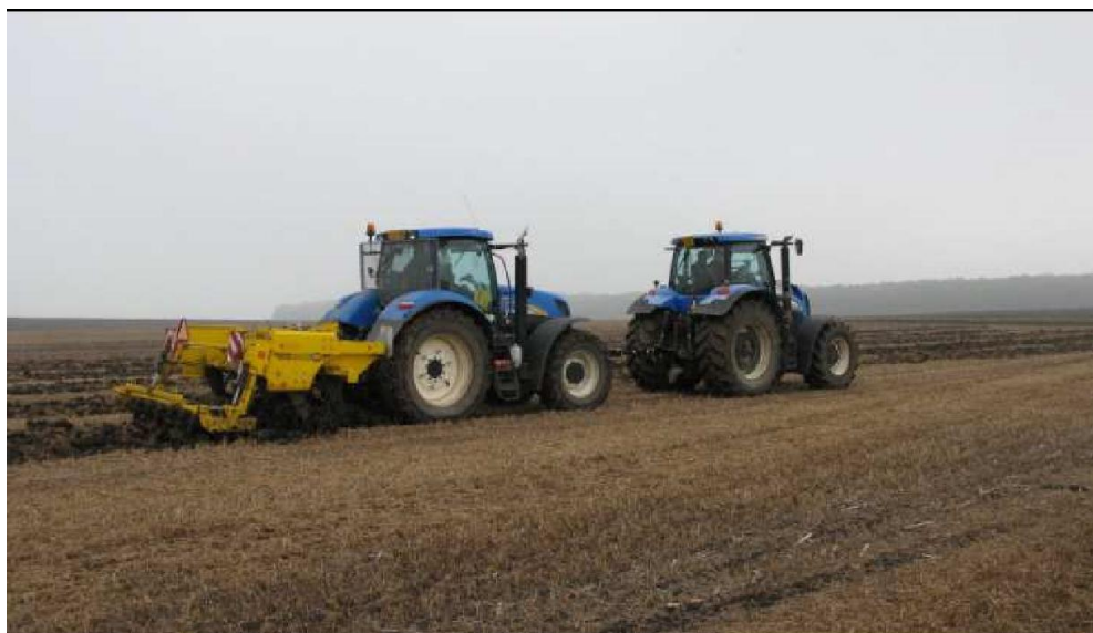
Obr. 4 Měření tahového odporu
