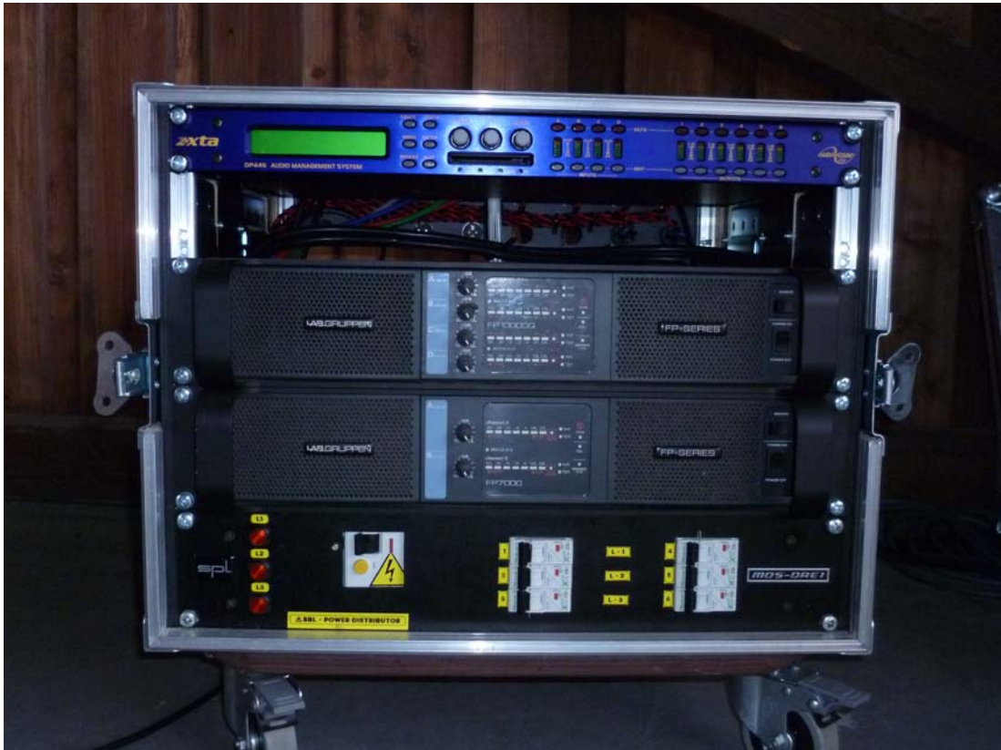
Foto 5 Zesilovače Lab Gruppen a signálové procesory XTA (Foto: Miroslav Zeman)
