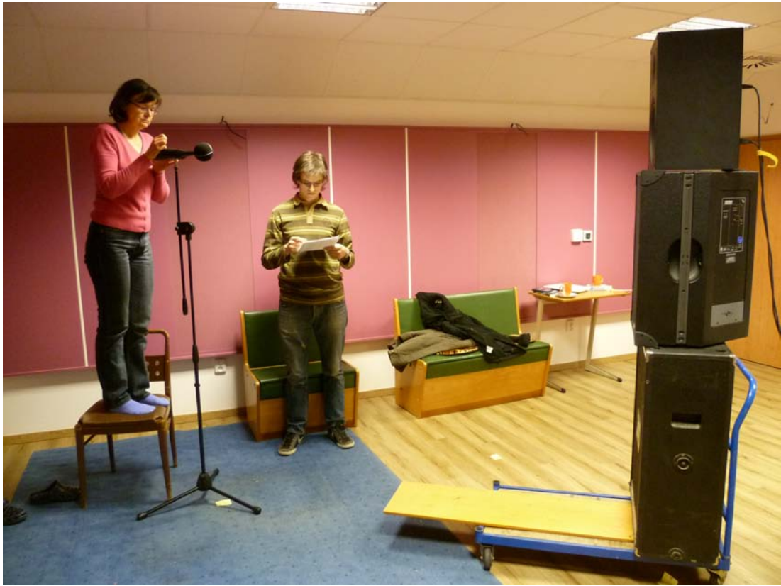
Foto 11 Měření v rohu č. 2 ve výšce 180 cm (Foto: Miroslav Zeman)
