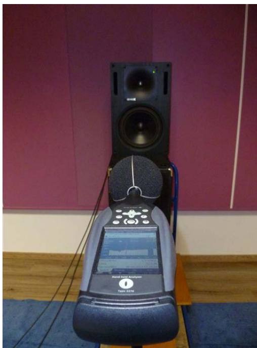
Foto 7 Měřicí přístroj BK 2270 a reproduktor Genelec (Foto: Miroslav Zeman)
