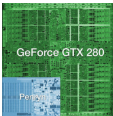
Obrázok 3.5: Porovnanie plochy jadra GeForce GTX 280 a dvoj-jadrového procesora Core 2 Duo, prevzaté z techreport.com
