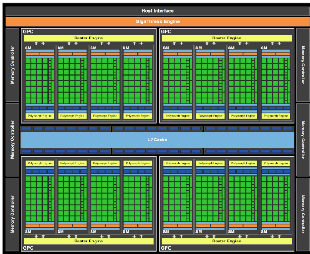
Obrázok A.1: Architektúra a hierarchické rozdelenie výpočetných jednotiek grafického čipu GF100 ešte podľa pôvodného návrhu so 16-timi multiprocesormi a 512 výpočtovými jadrami, pre ilustráciu ku kapitole 3.2.2, prevzaté z [17]
