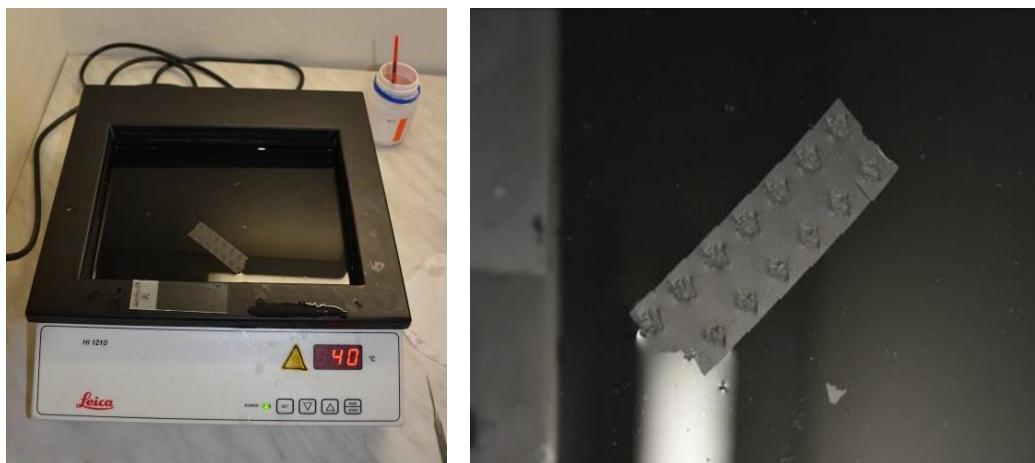
Obr. 29 a 30 Ponoření řezů do vodní lázně o teplotě 40°C (fota autorka)
