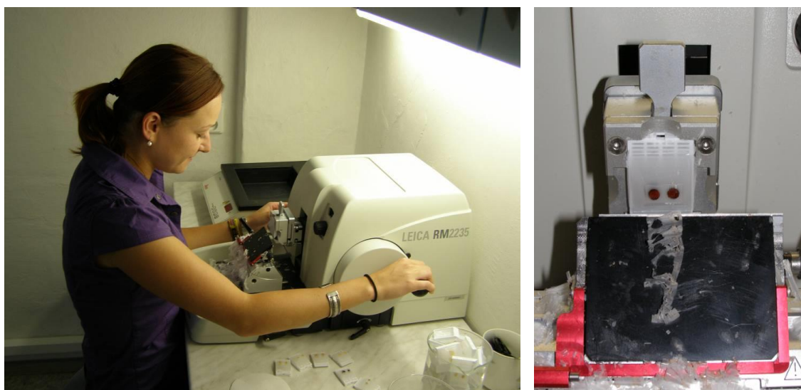
Obr. 27 a 28 Zhotovení sériových řezů (foto G. Vichrová, autorka)
