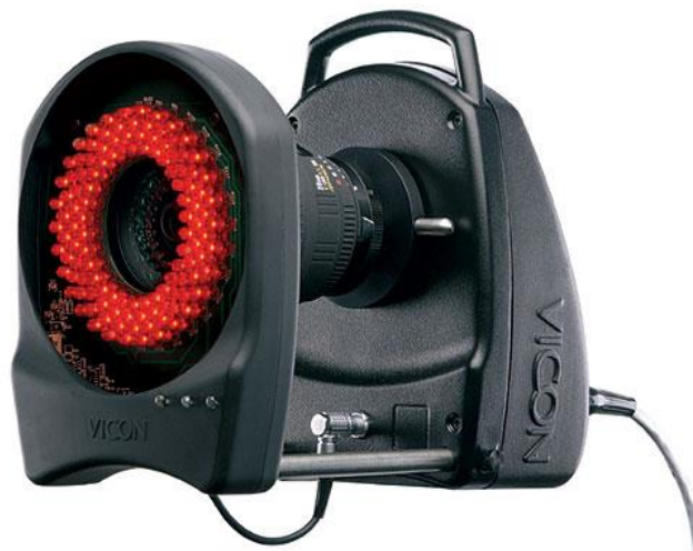
Obr. 6: IR kamera Vicon [3].
