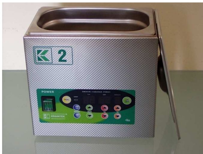
Obr. č. 10 Ultrazvuková lázeň Kraitex 5, typ K-2LE
