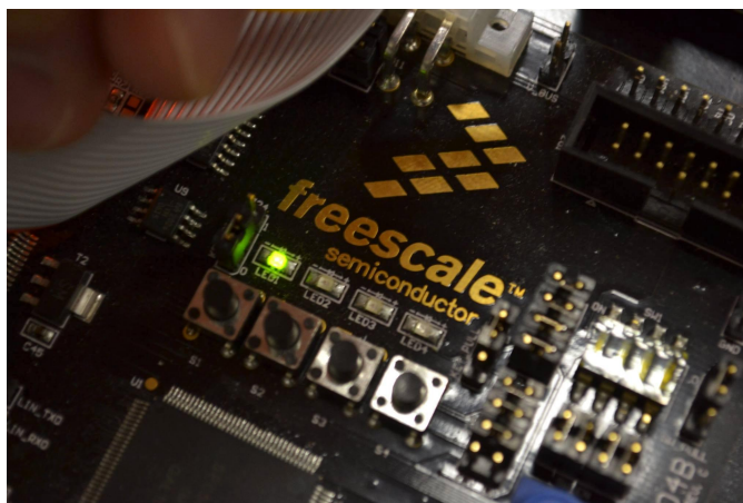
Obrázek 3.5: Uživatelské LED diody a tlačítka na desce
