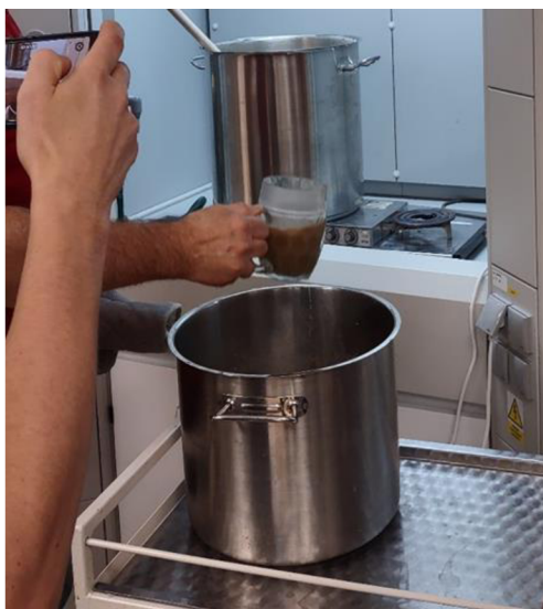
Obrázek 5-14 Přesun části obsahu první varné nádoby do druhé varné nádoby
