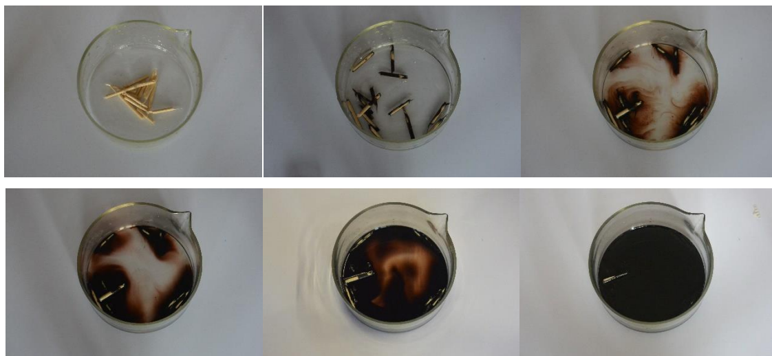
Obr. 23: Reakce dřevěných třísek s kyselinou sírovou (foto autoři)
