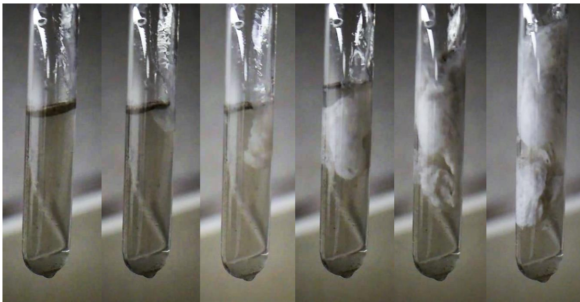
Obr. 20: Reakce roztoku dusičnanu stříbrného s roztokem chloridu sodného (foto žáci)
