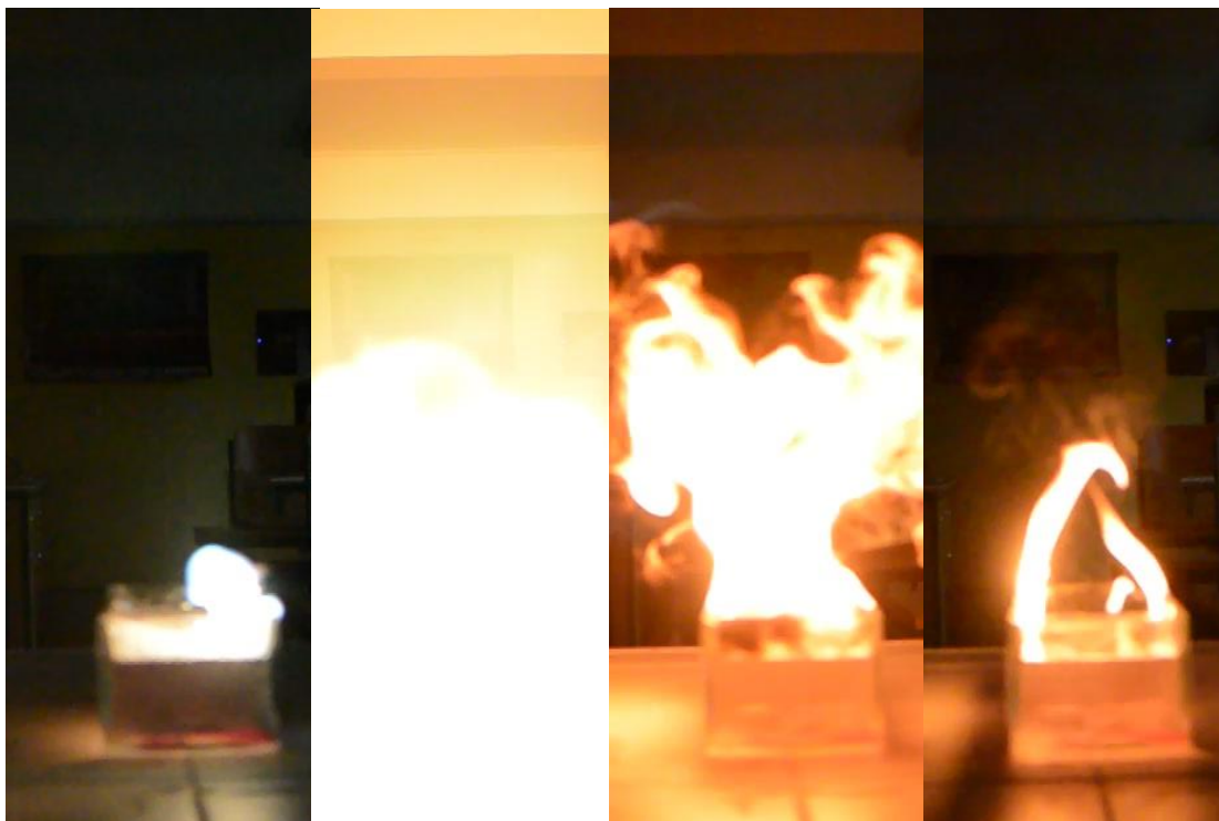
Obr. 25: Zapálení bublin naplněných ethynem (foto žáci)
