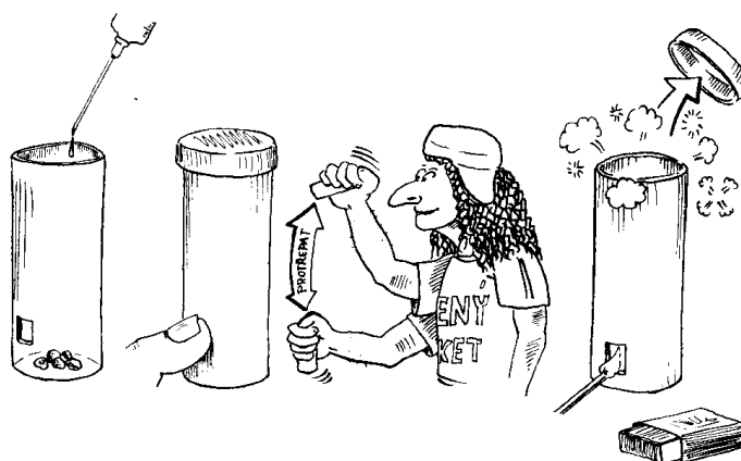
Obr. 1: Exploze palivové směsi (Los, Hejsková, Klečková, 1997)
