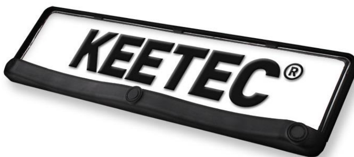
Obr. 20 Rámeček na registrační značku s třemi ultrazvukovými senzory [35]
