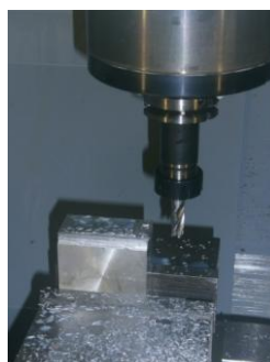
Obr. 6.4 Ukázka experimentu měření vytížení motorů
