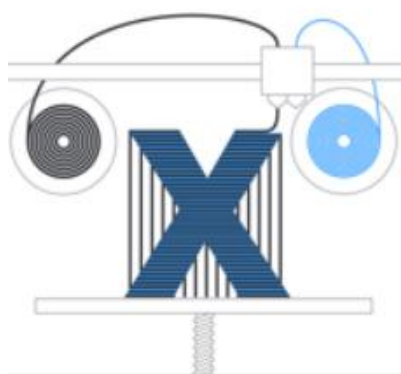
Obr. 1.17 Náčrt kontinuálnej FDM tlače pomocou dvojitej tryskovej hlavy a ukážka laserovej mapy tlačiarnie X3 Markforced [36].
