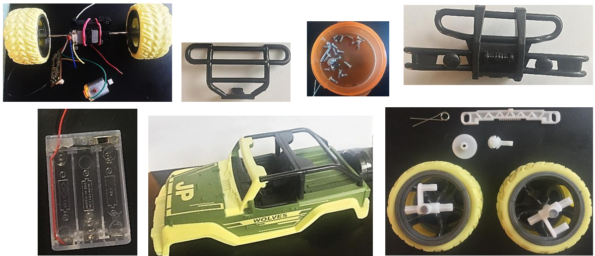
Obr. 1.41 Hotové diely modelu jeepu: (horná rada zľava) motor a zadná náprava, spojovací materiál, zadný blatník, predný blatník; (dolná rada zľava) schránka na baterky, karoséria, predné kolesá a prvky nápravy.
