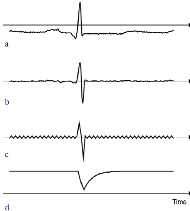
Obrázek 3.3 Postupná úprava signálu při extrakci rysu. a) originální signál, b) signál po filtraci pásmovou propustí, c) signál s přidanou vysokofrekvenční složkou, d) detekce průchodů nulou [12]
