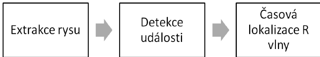
Obrázek 3.1 Blokové schéma detektoru založeného na počítání průchodů nulou [12]
